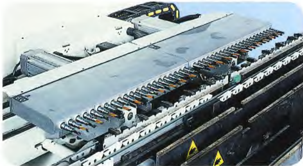
Horizontale Bohrköpfe mit 21 unabhängigen Spindeln
