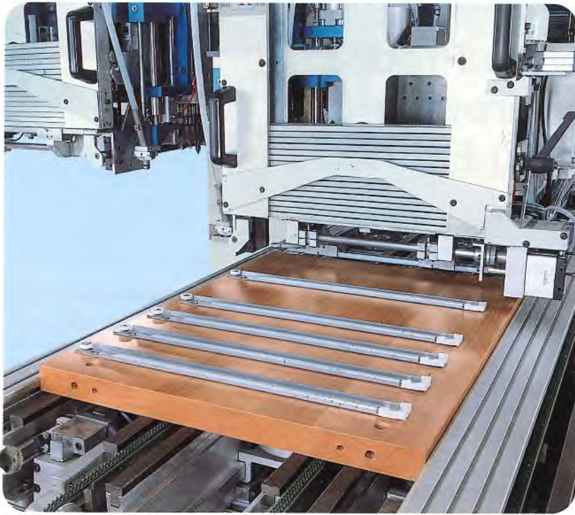
Einsetzen von Schubladenschienen.
